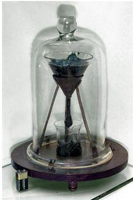
Demonstration der hohen Viskosität von Pech im Pechtropfenexperiment
